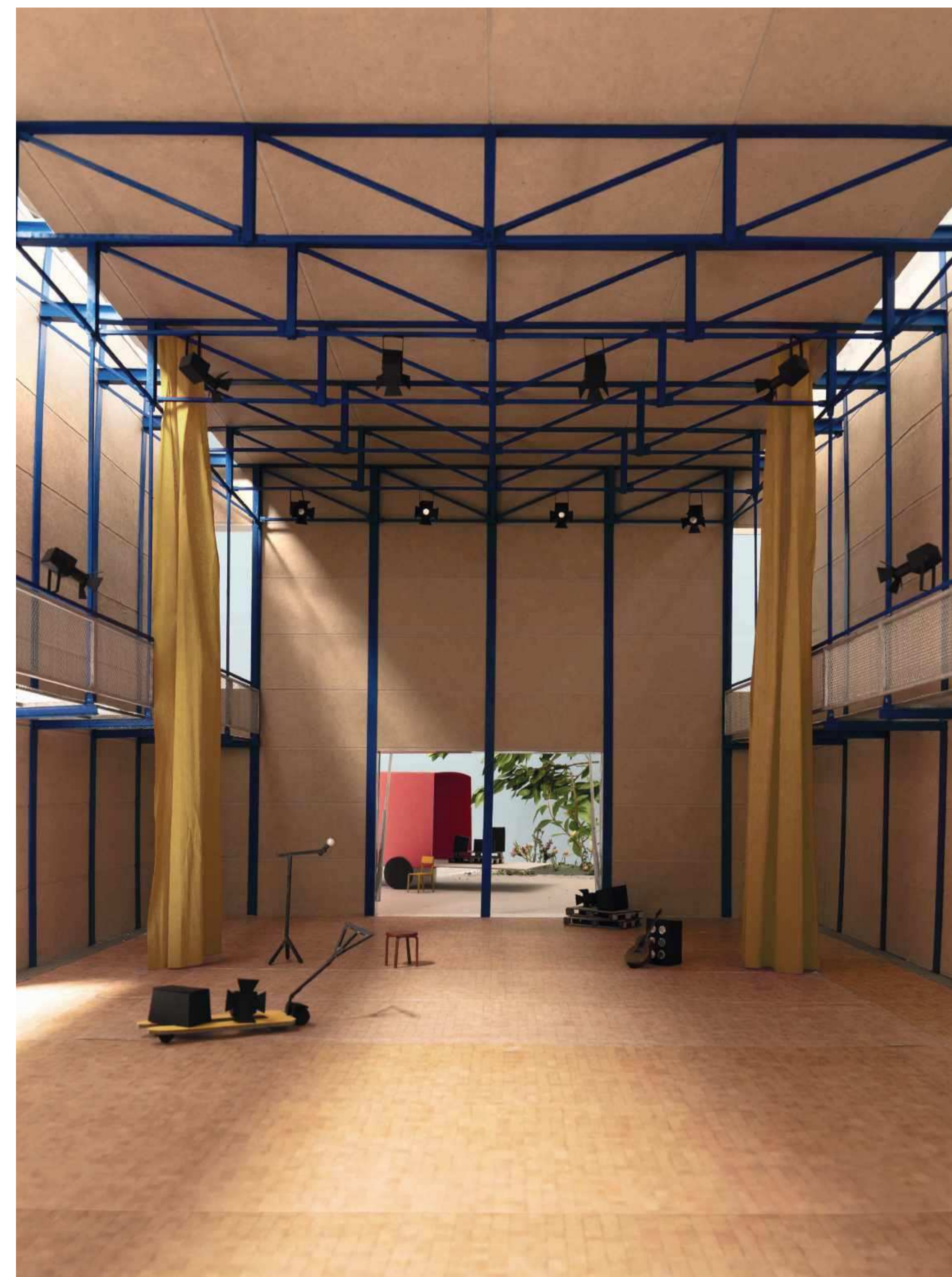
La nouvelle salle polyvalente avec la structure marquante en acier réutilisé et les murs en argile, ainsi que le sol en parquet sur chant. Les matériaux naturels et la composition de l'espace ainsi que la gestion de la lumière donnent à la salle une atmosphère solennelle. La salle peut être transformée en divers scénarios grâce à des éléments de sol réglables en hauteur et offre une flexibilité maximale aux utilisateurs.
