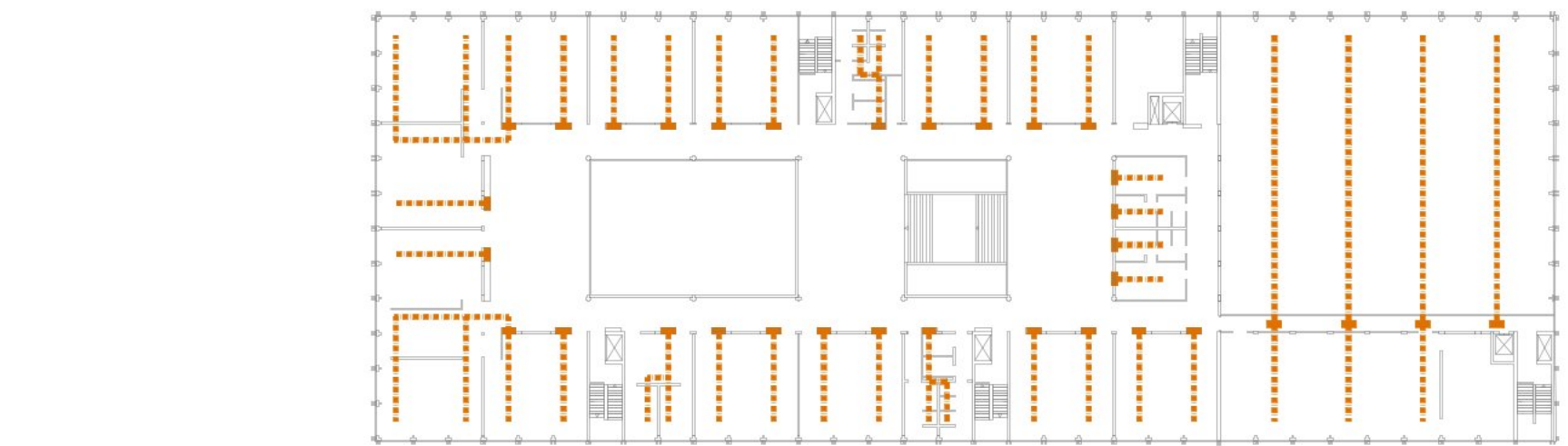
Concetto distribuzione al piano (ventilazione meccanica)
