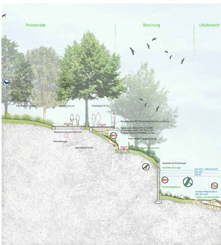
SCHNITT FF, HISTORISCHER TREPPENABGANG, M 1:100
