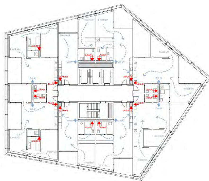
Horizontale Lüftungsverteilung, 1:333
