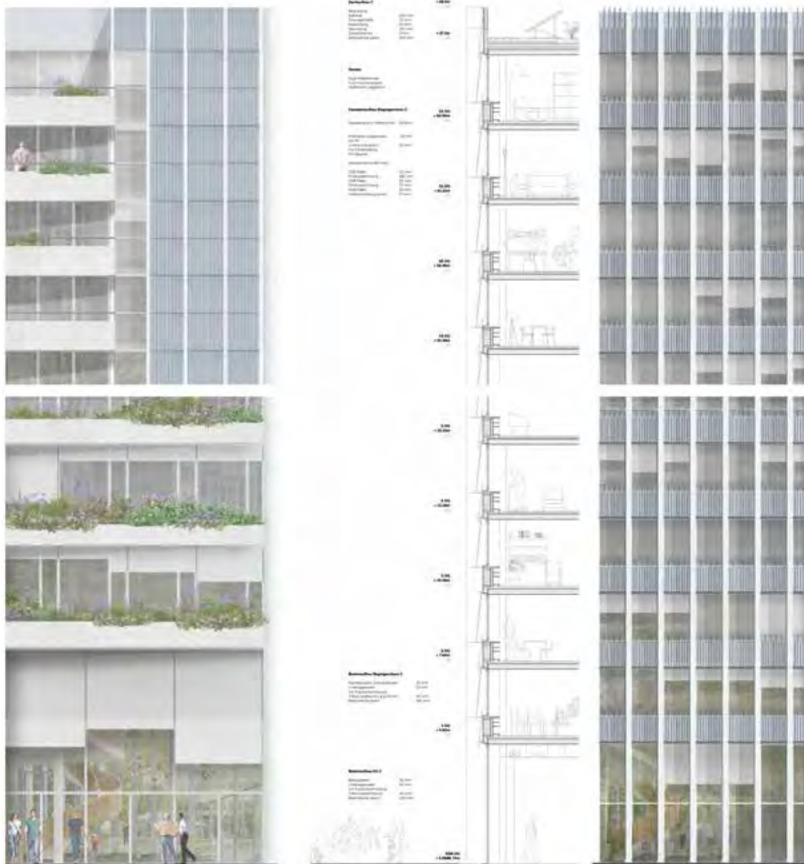
Fassadenansicht und -Schnitt
