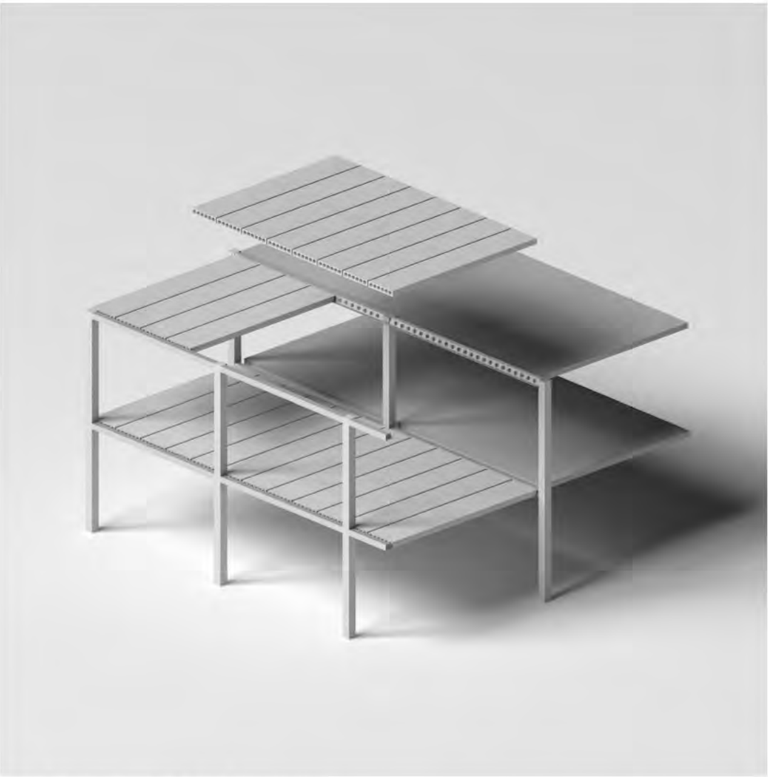
Detail Delta Beam & Hohlblechdecke
