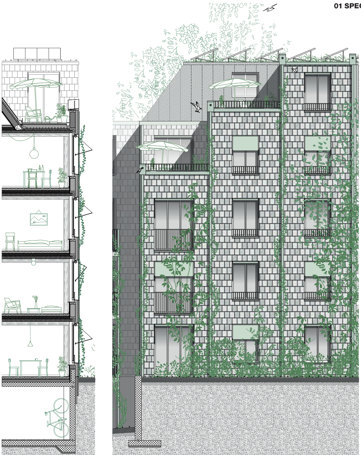
Konstruktionsschnitt und Ausschnitt Fassade 1:100
