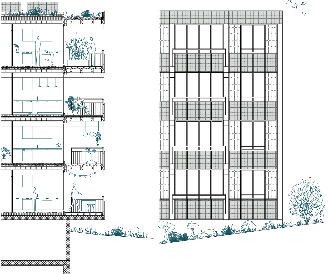
Konstruktionschnitt und Ausschnitt Fassade 1:100
