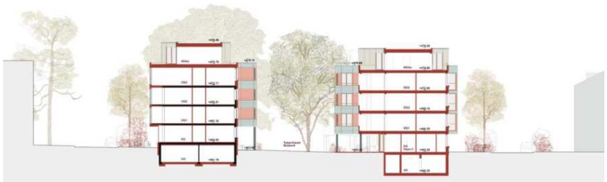
Abb. 7 Geländeschnitt, Bestandserhalt links, Neubau rechts, Alveole
