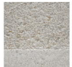
Oberflächenbearbeitung (gestockt/gestrahlt) AssCrot-Beton mit Kalksteinzuschlag
