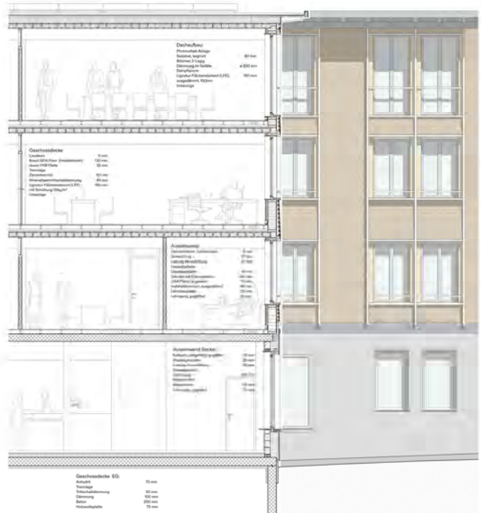
Konstruktionsschnitt und Fassadenansicht 1/50
