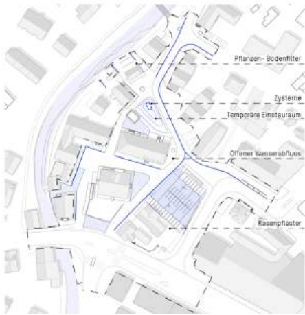
Entwässerung und Retention
