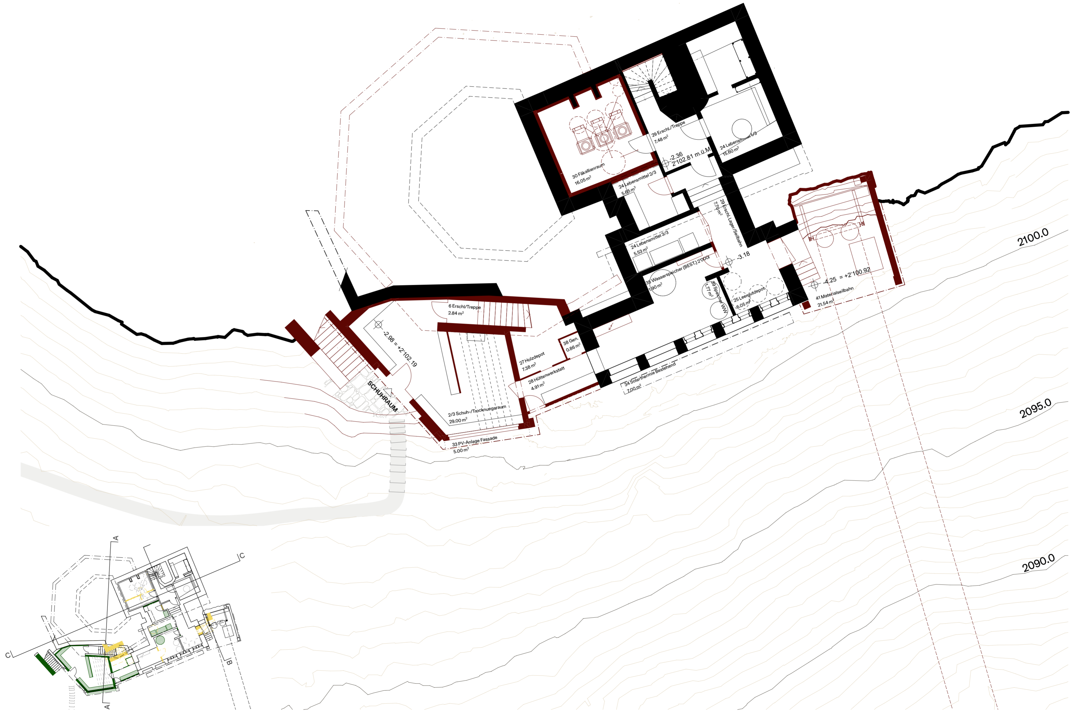
Sockelgeschoss 1:100 | Schema Abbruch & Wiederverwendung 1:300
