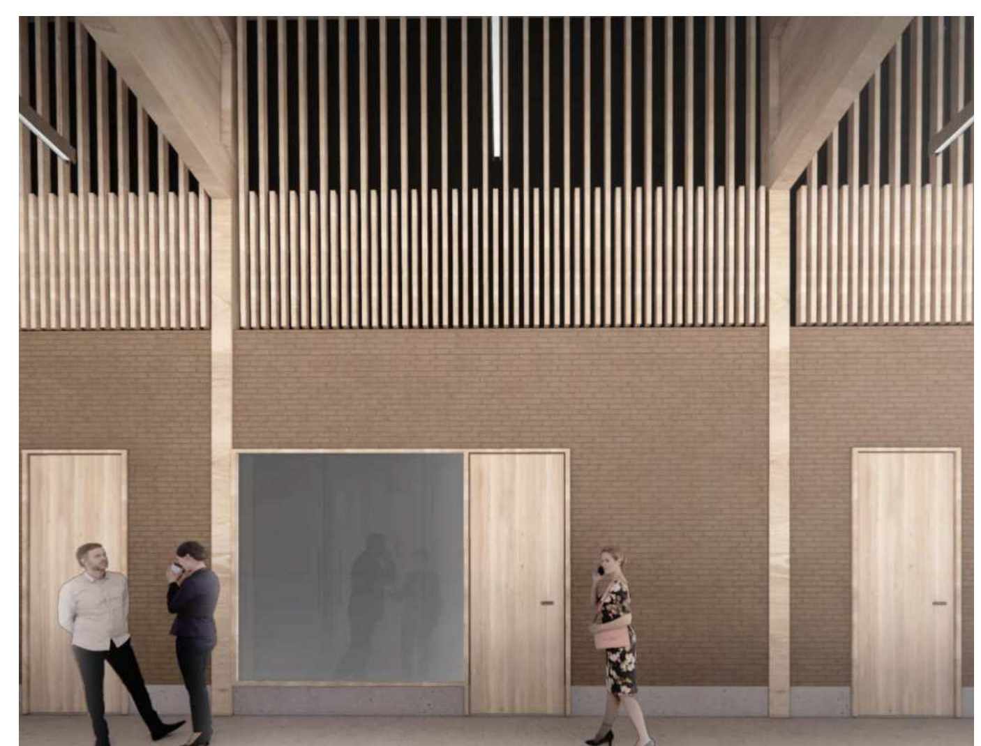
VUE INTERIEURE - PAROIS EN BRIQUES DE TERRE CRUE TYPE TERRABLOC
