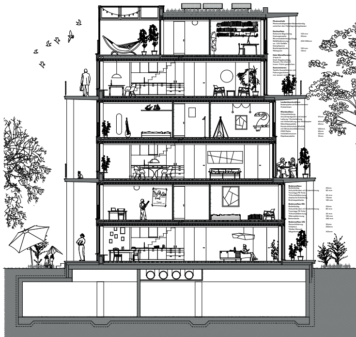
Fassadenanschnitt Gebäude Landl Teilbereich "bezahlbarer Wohnraum" 1:50
