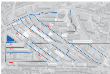
Reaktiviertes Rückhaltebecken - Leitungsnetz Dreispitz
