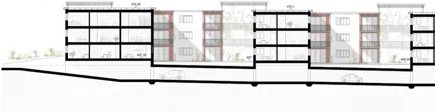
Baubereich N: Querschnitt Treppenhaus, 1:200 (verkleinerte Darstellung)
