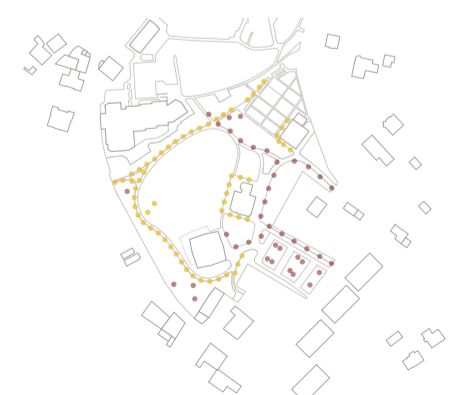
Diagramme éclairage public : ■ mâts 3m ■ bornes basses 60cm Éclairage 3'000K sur programmation horaire selon image directrice cantonale
