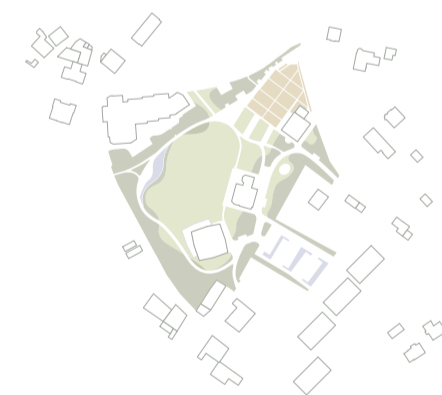
Diagramme de végétation : ■ complément de vivaces et arbustes de sous-bois > 6'180m 2 ■ prairie fleurie, mélange UFA > 6'343m 2 ■ jardin de pluie et noues > 400m 2 ■ cultures potagères > 1'250m 2 > soit 67% en sol naturel et/ou restitué en pleine terre
