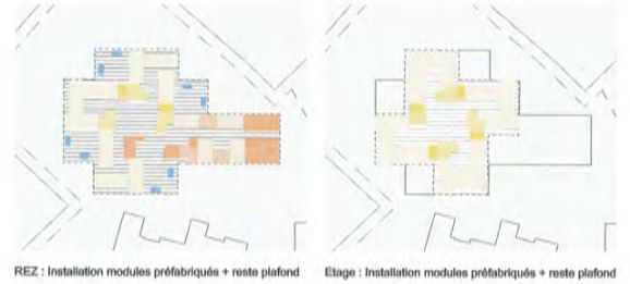
REZ : Installation modules préfabriqués + reste plafond
