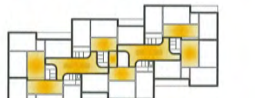
Éclairage zénithal des espaces de distribution
