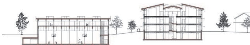
Längsschnitt Sportgebäude, Querschnitt Schulhaus 1:1000
