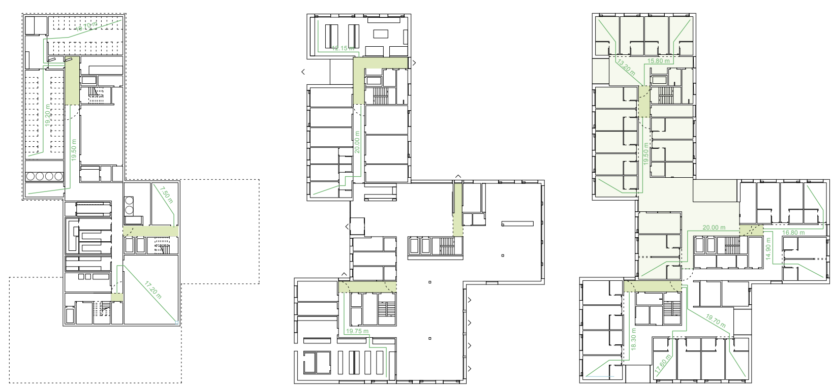
Les étages de chambres sont divisés en 2 unités de 13 chambres chacune assurant le transfert horizontal d'une unité à l'autre. Les distances de fuite jusqu'à une cage sécurisée sont toujours inférieures à 20 mètres.
