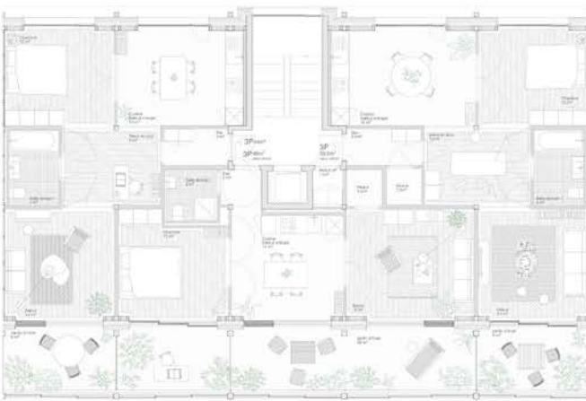
Desin de l'aménagement type des 3 pièces | échelle 1:50
