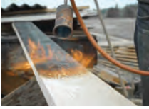
Lames de sapin brutes brûlées au chalumeau (Shou Sugl Ban)
