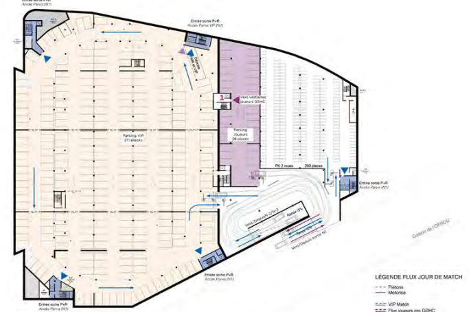
N-1 NIVEAU PARKING -11.35 m ECH 1/500 Les joueurs arrivent plusieurs heures avant le match, en dehors des heures de pointe de sortie P+R. Ils ne sont donc pas en conflit avec les flux sortants.
