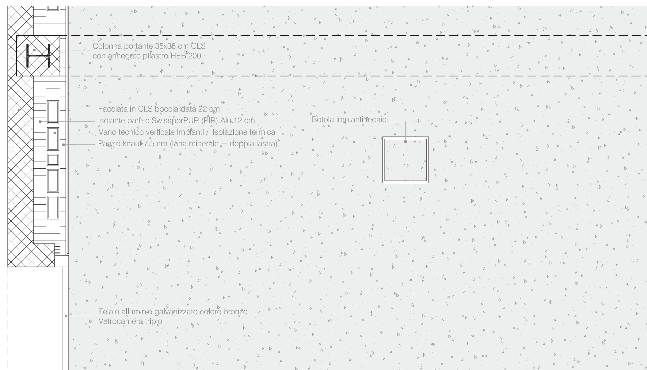
dettaglio 1.20 - pianta pavimenti
