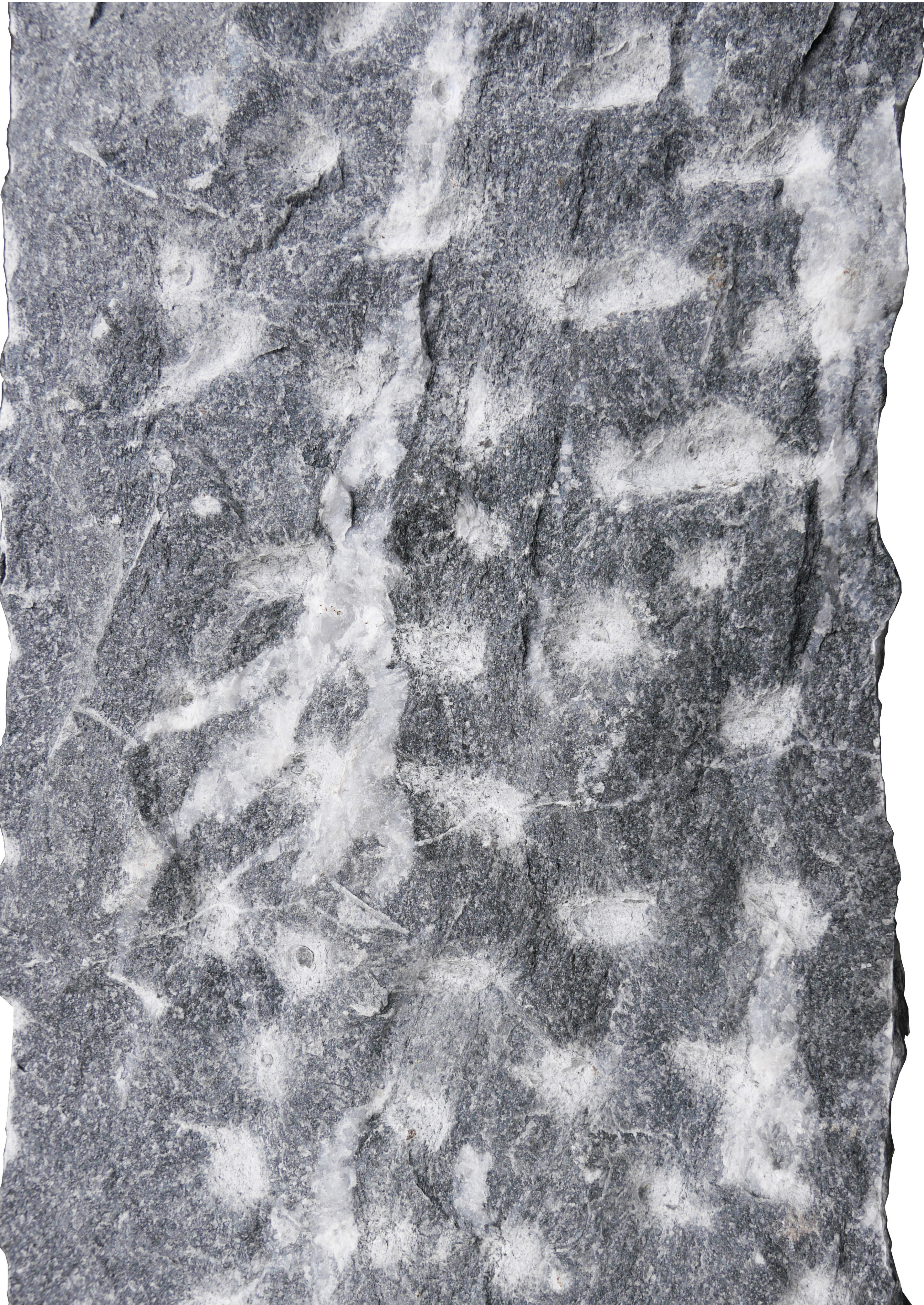
Kieselkalk Frasteals behauene/gespitzte (bildhauerische Bearbeitung) neue Stelen/Wandpilaster als Verbindung zu den reuse Kranzsteinen
