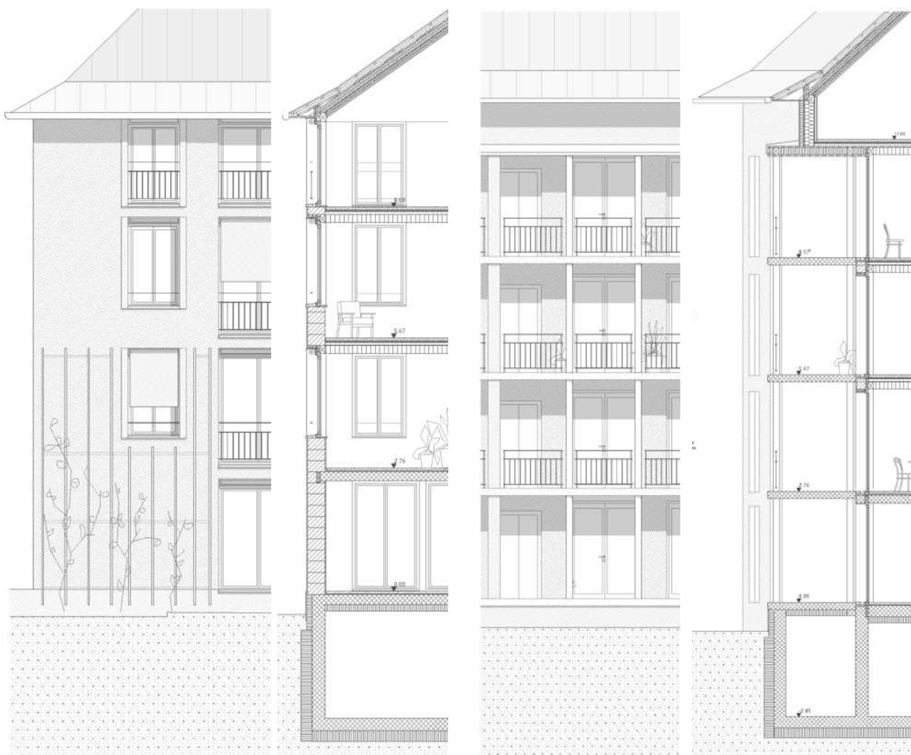
Konstruktionsschnitte Haus A und Laubenschicht
