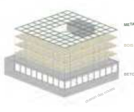
STRUCTURE, UN BÂTIMENT EN BOIS SUR UN SOCLE EN BÉTON
