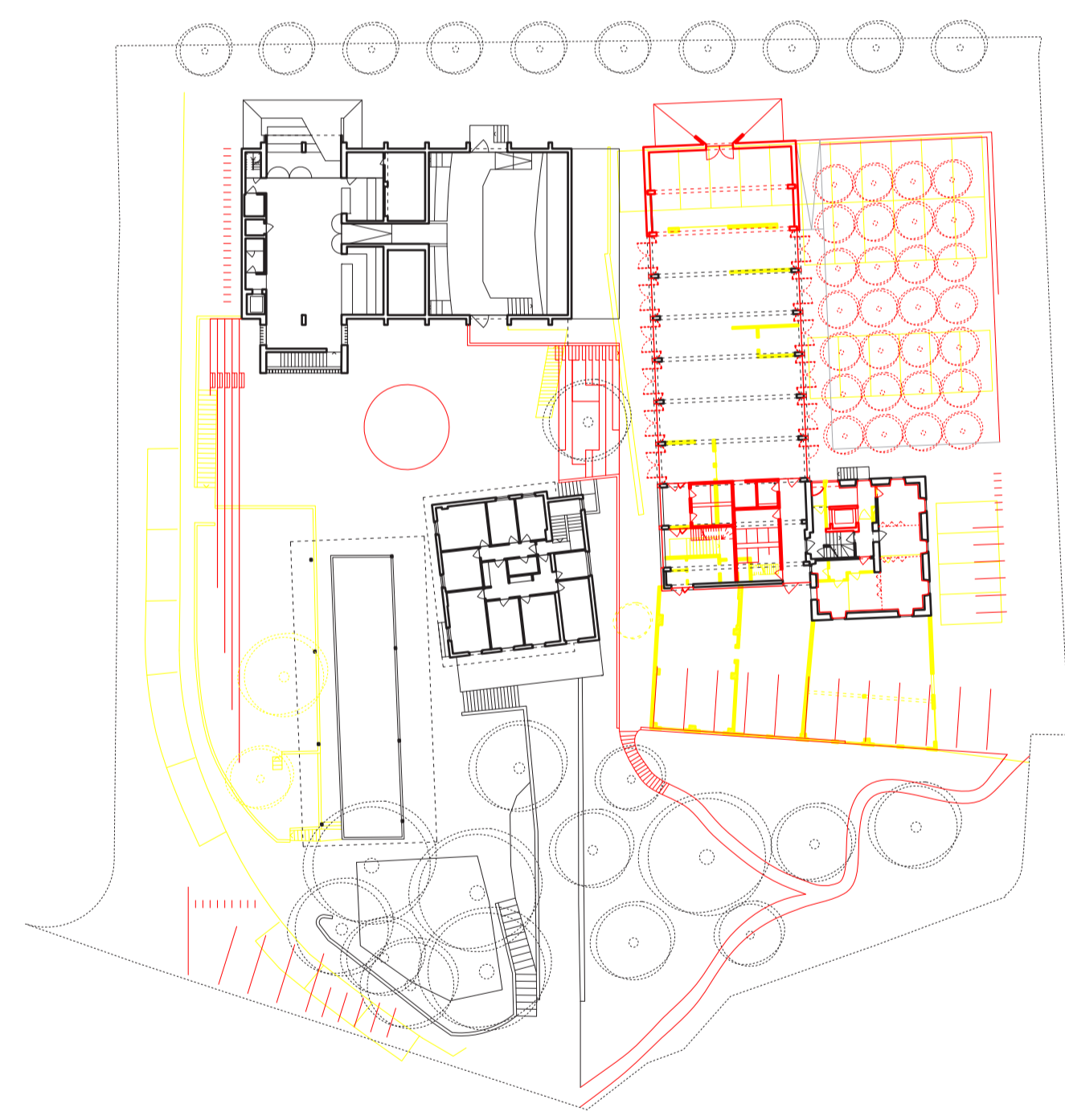
Schemi Nuovo (rosso) e Demolizioni (giallo) Piano Terra
