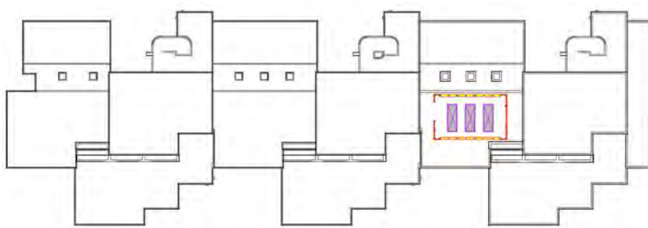
Tetto scuola con ubicazione delle 3 nuove pompe di calore aria-acqua
