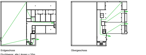
Erdgeschoss Fluchtweg: alle Längen < 35m
