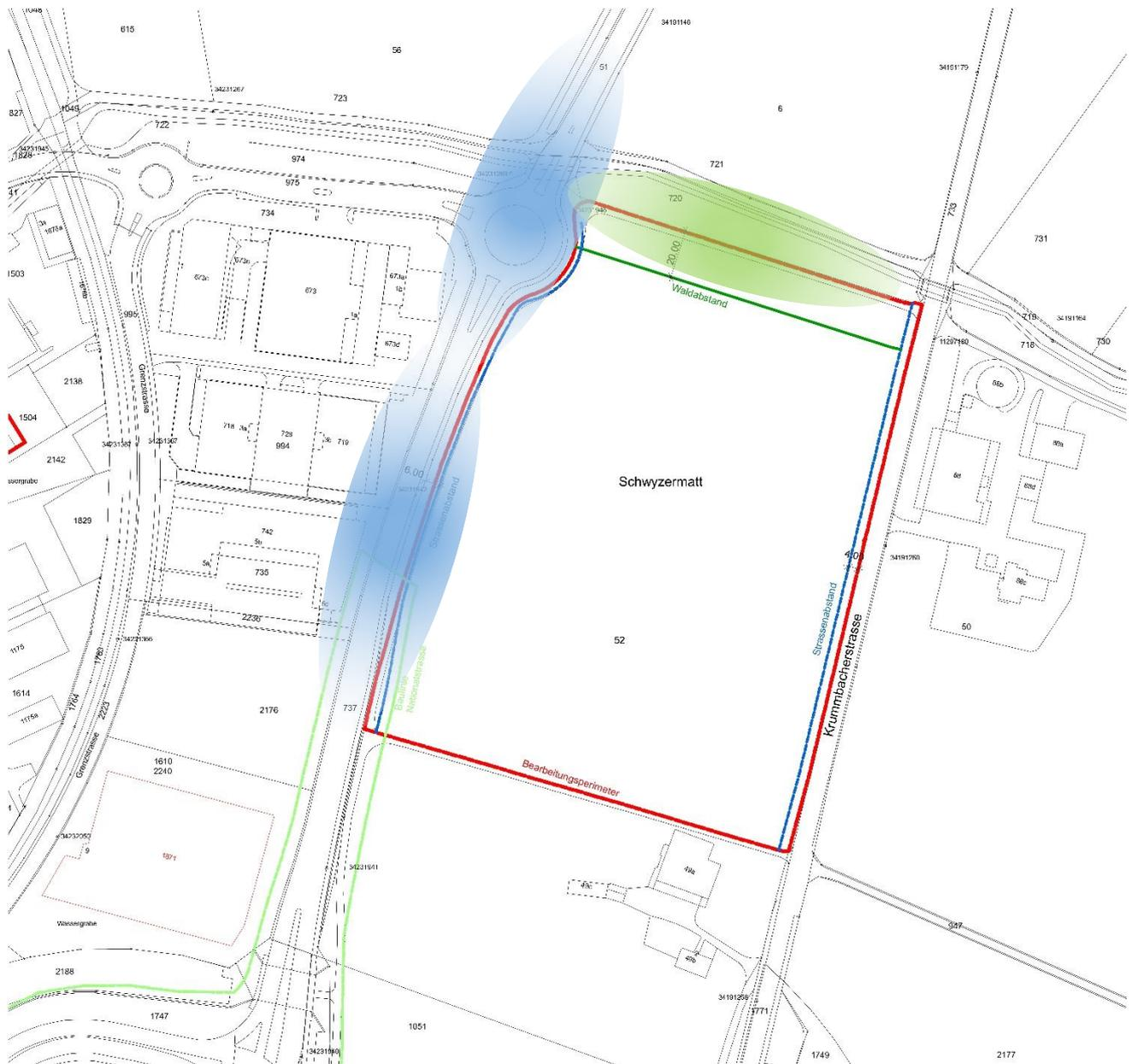
Abbildung 6: Situationsplan mit Perimeter, Abständen und Baulinien (amtl. Vermessung, Abbildung massstabslos)
