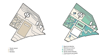
Réajustage de la terre d'excavation pour aménagement sur site
