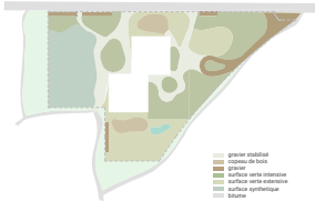
Traitement des sols
