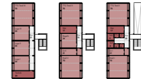
Schulprovisorium Das Programm des Bauprovisoriums findet in einem schlanken dreigeschossigen Kasten Platz.
