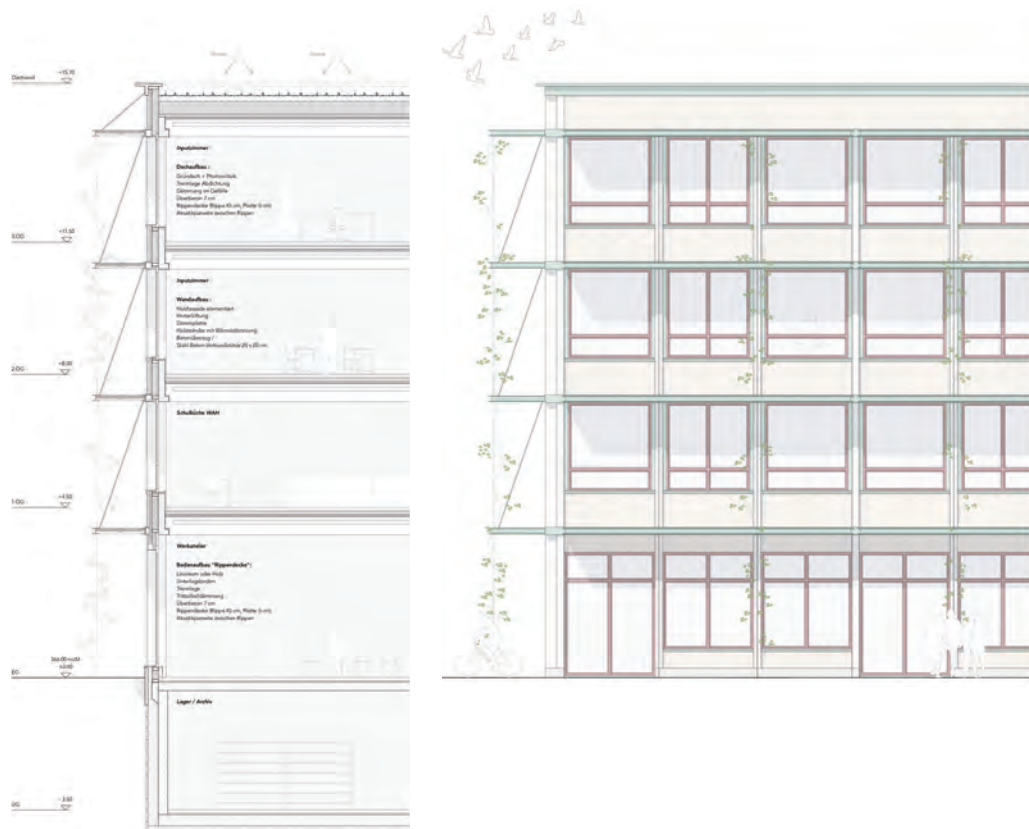
Fassadenschnitt und Ansicht
