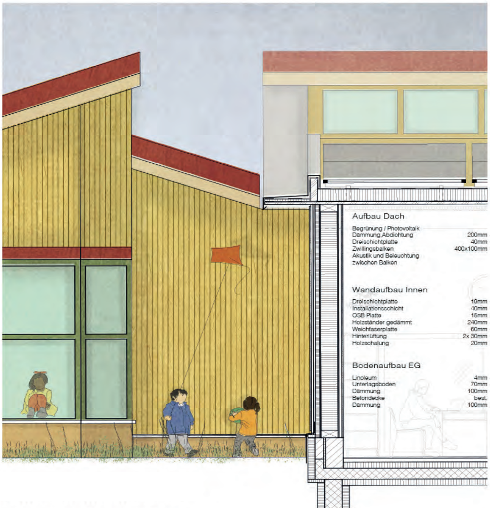
Konstruktionsschnitt
