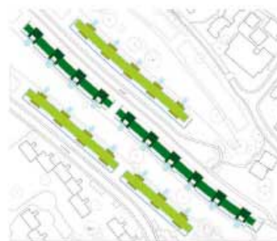
Konzept zur Vereinbarkeit von Dachbegrünung und Photovoltaik
