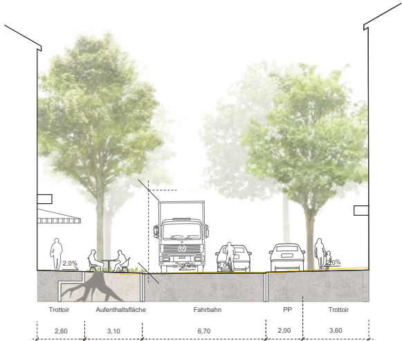
Schnitt D-D' Hauptstrasse, M 1:100 Baumentwicklung: 50 Jahren
