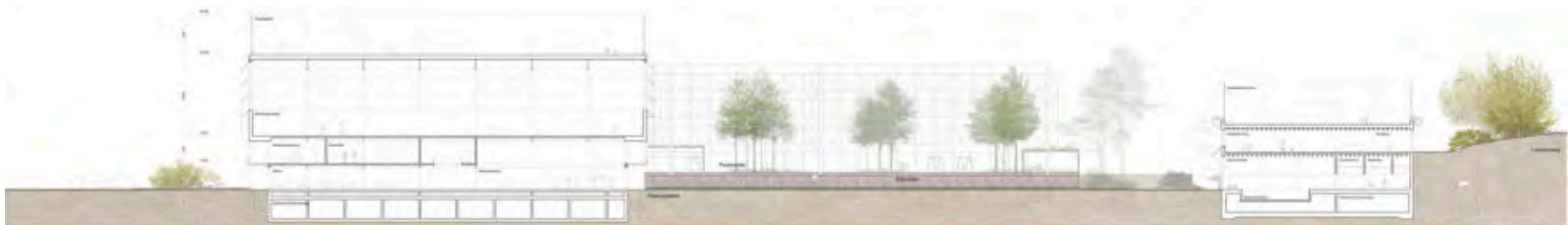
Längsschnitt Areal, Kopfbau und Schwimmhalle, Kindergarten 1:1000
