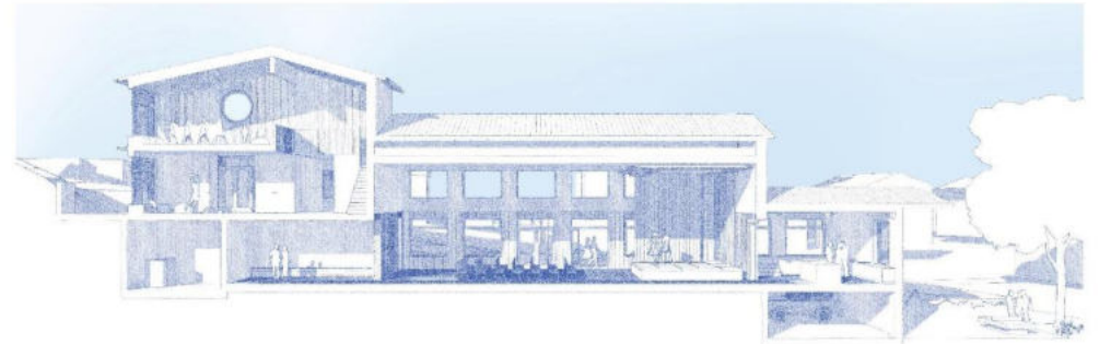
Schnittperspektive durch den Mitteltrakt mit Blick auf die neue Treppe und hinaus auf den Pausenplatz.
