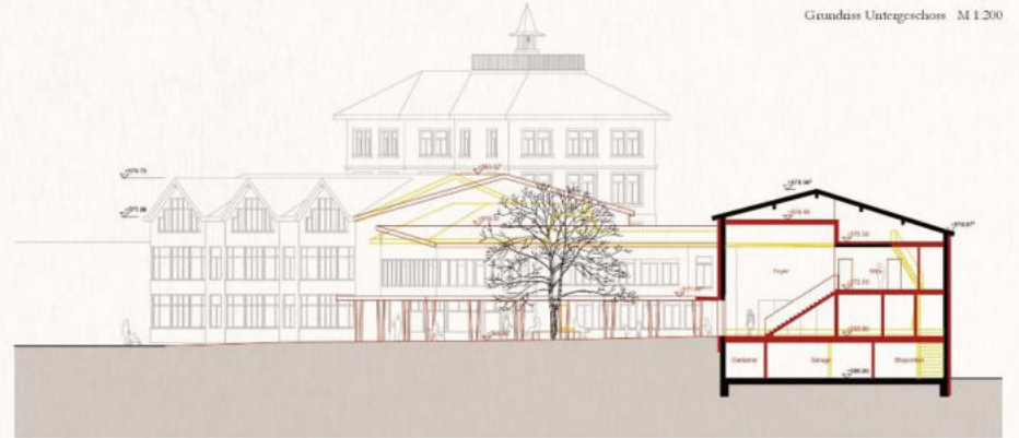
Schnitt B-B / Querschnitt Foyer (alter Bühnenraum) M 1:200
