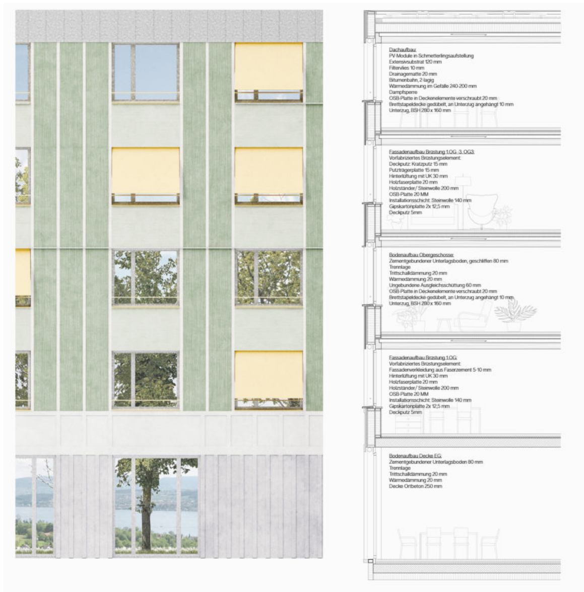
Fassadenansicht und -schnitt
