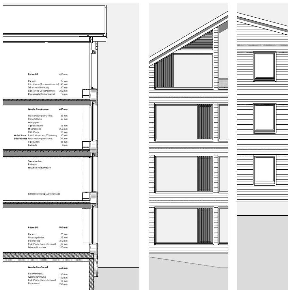
Abb. 38: Fassadenschnitt ZAI (massstabslos)
