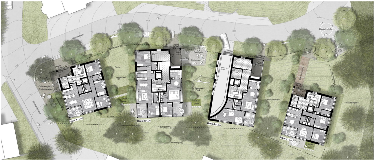
Abb. 18: Regelgeschoss (1. OG) Quartett (massstabslos)
