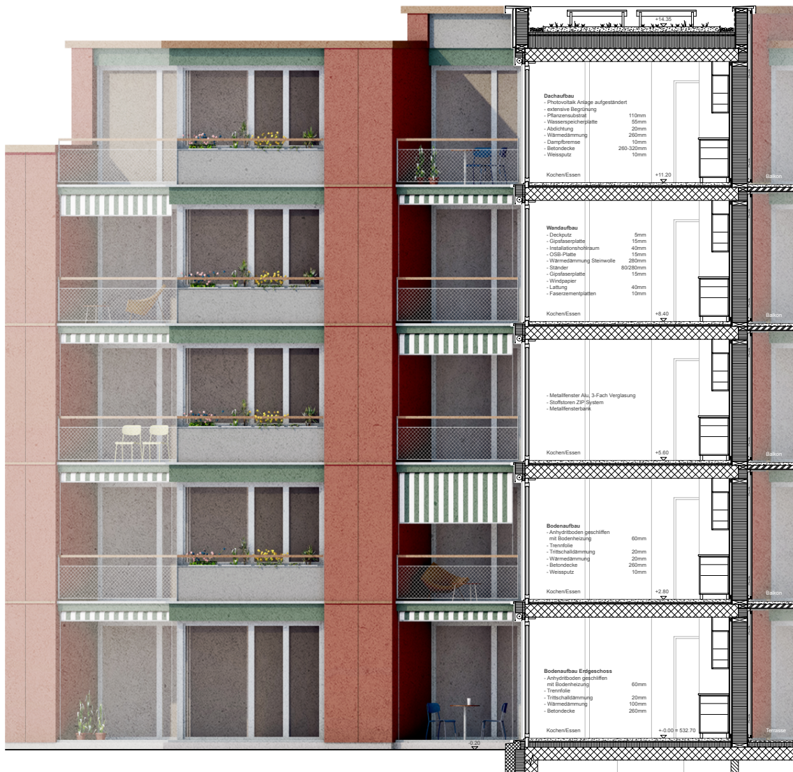
Fassadenschnitt und Ansicht 1:50 (verkleinert)
