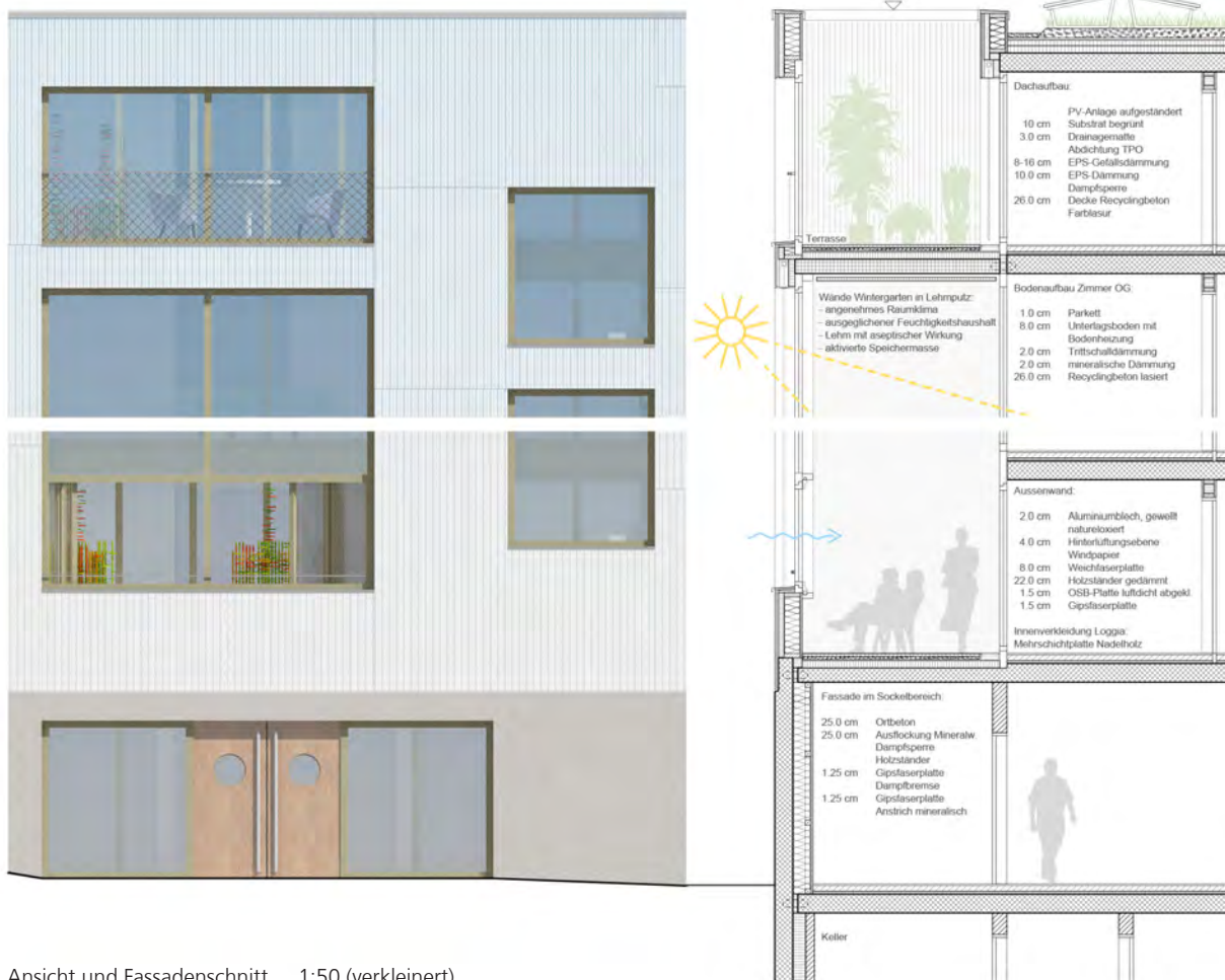
Ansicht und Fassadenschnitt 1:50 (verkleinert)
