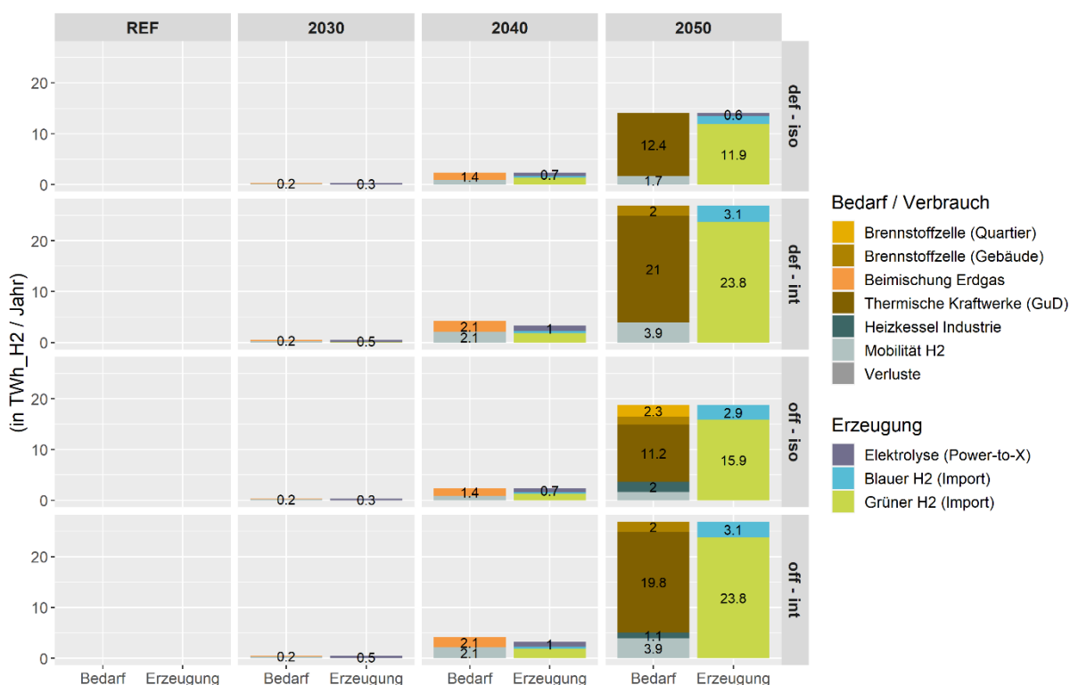
Abbildung 22 Wasserstoffbilanzen der vier Szenarien für die vier gewählten Stützjahre.
