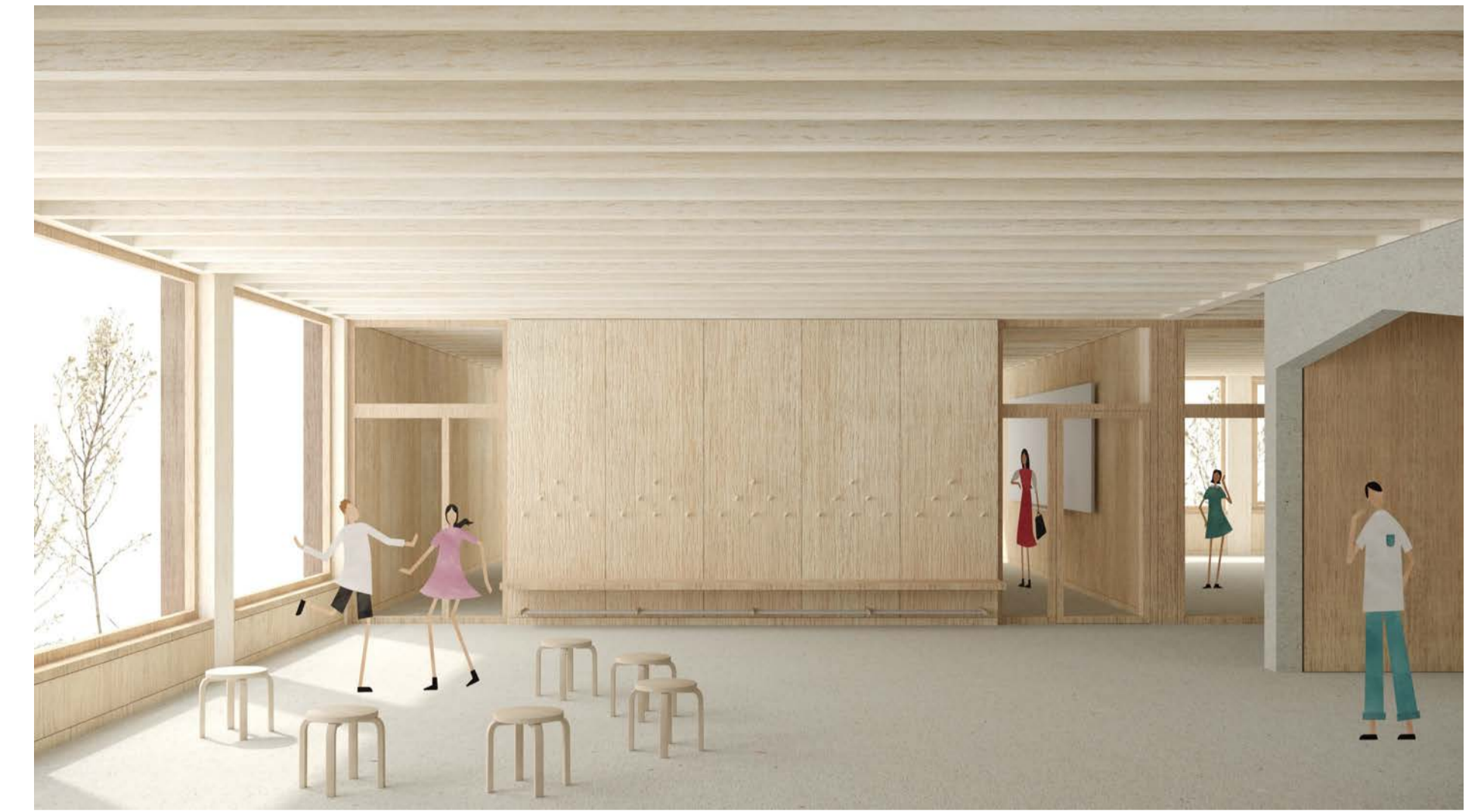
Vue Hall étages école En regard de la configuration AEA1, les halls de l'école peuvent recevoir du mobilier et accueillir des activités communes temporaires entre classes. L'efficacité structurale des planchers mixtes, combinés aux voiles porteurs, permet d'optimiser les volumes construits; la hauteur statique utile étant intégrée dans la structure verticale.
