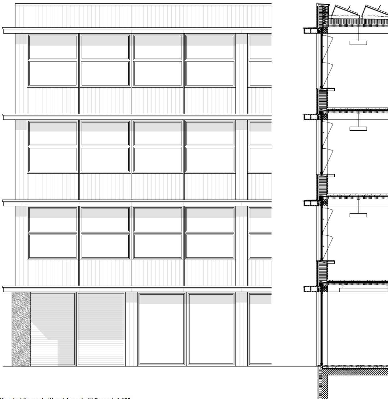
Konstruktionsschnitt und Ausschnitt Fassade 1:100
