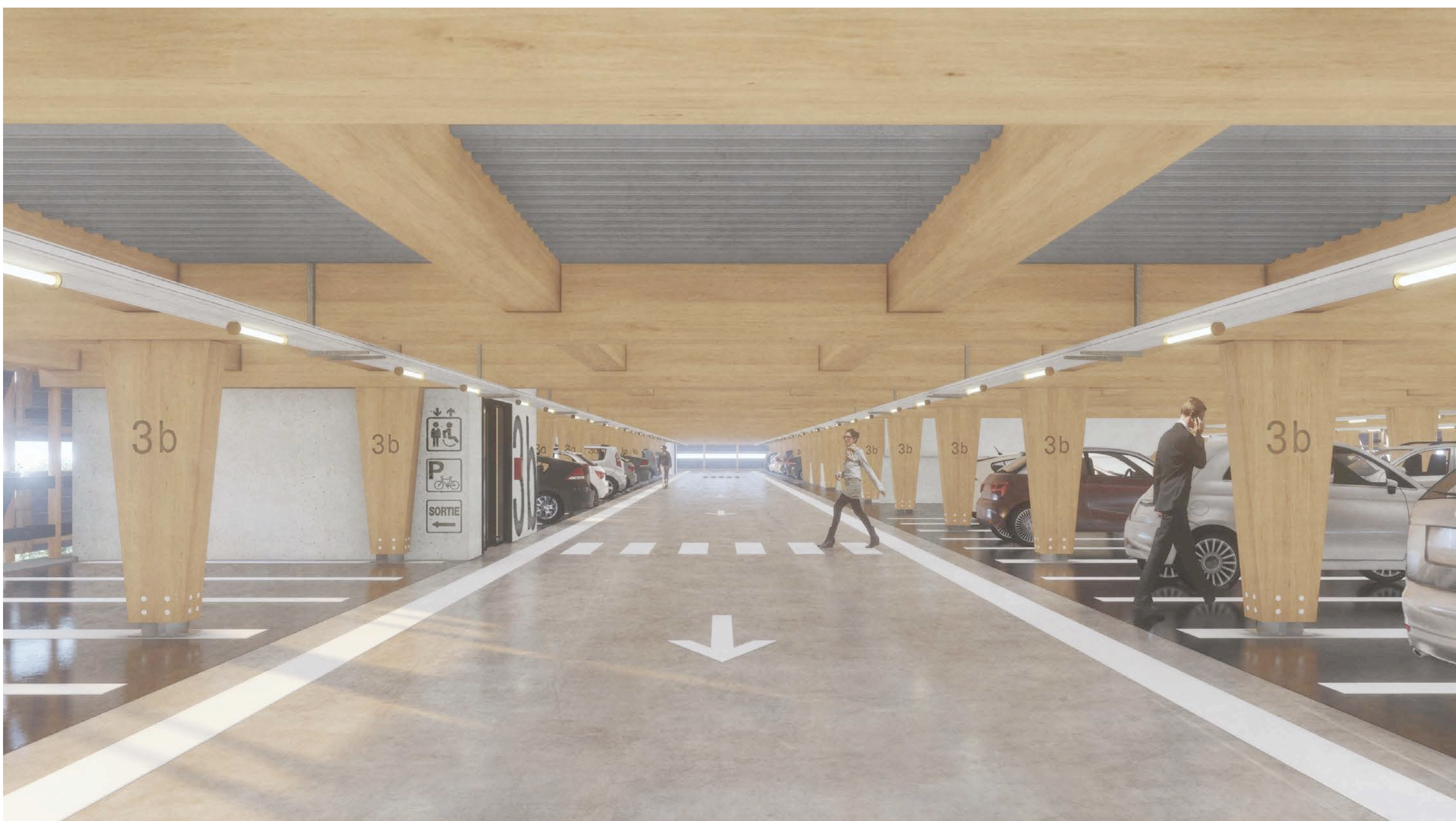
Structure principale en bois de frêne lamellé-collé (type FAGUS)
