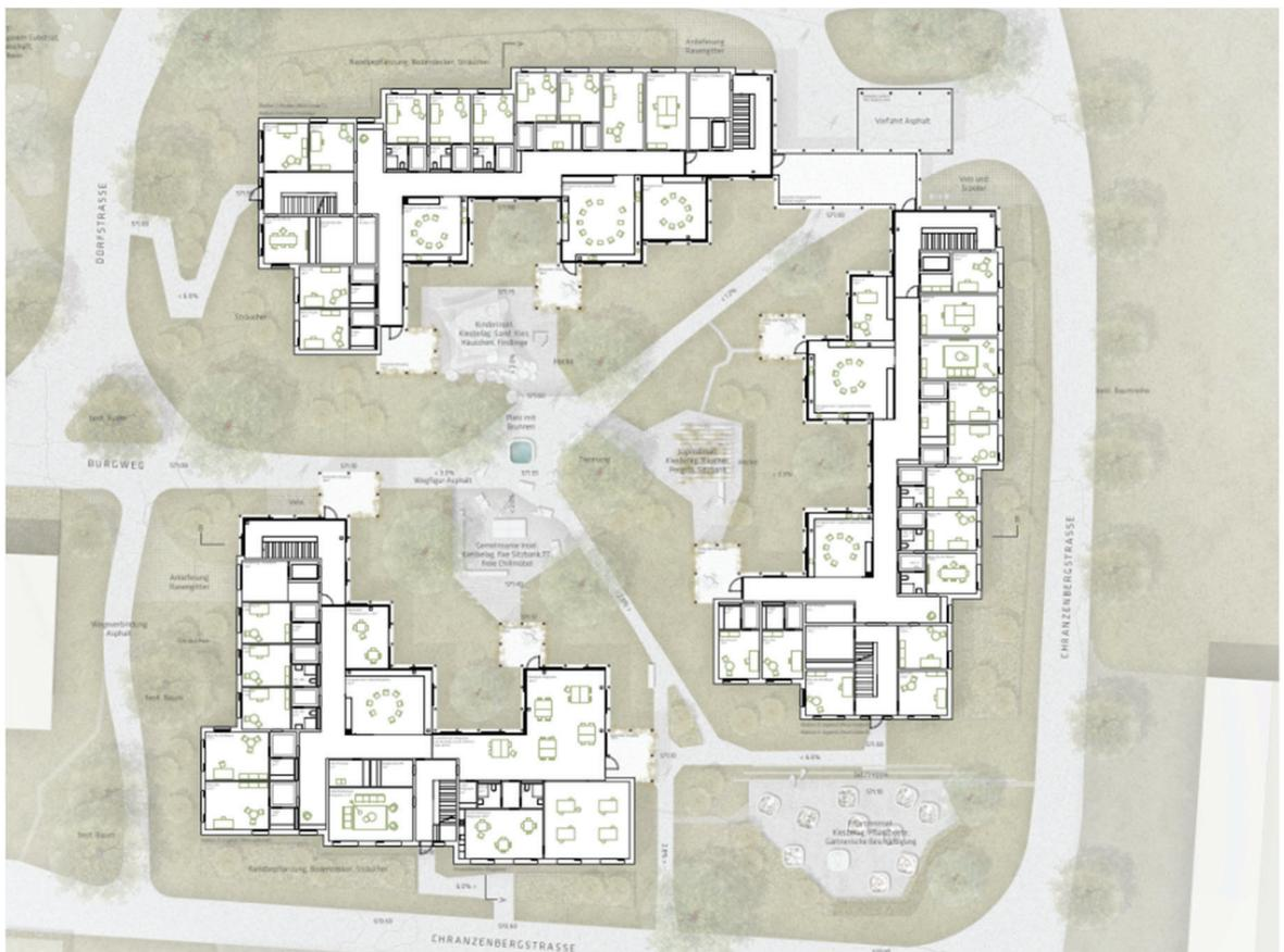
Grundriss Erdgeschoss (inkl. Option einer fünften und sechsten Station)
