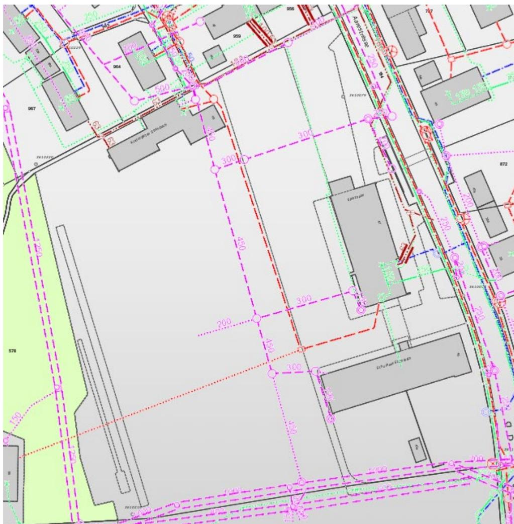
Abbildung 5: Abwasser: violett, Wasser: blau, Elektrizität: rot, Kommunikation: grün, Gas: dunkelrot
