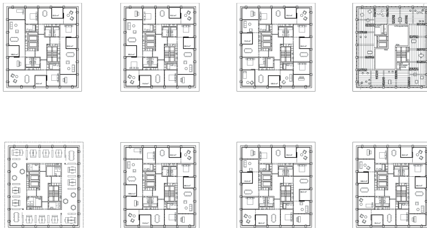
Abb. 21 Grundrisse Obergeschosse 2. Sockelgeschoss bis Attika
